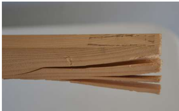
Rugosité volumique due à l'arrachement surfacique des couches fibrées successives
