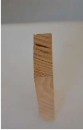
Encoche préliminaire réalisée entre deux couches fibrées
