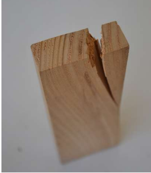
Faille révélant un interstice entre deux couches et donc le coeur de l'échantillon
